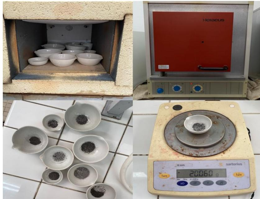
**Figure 15 :** Méthodologie de mesure du taux de carbone dans notre expérience
