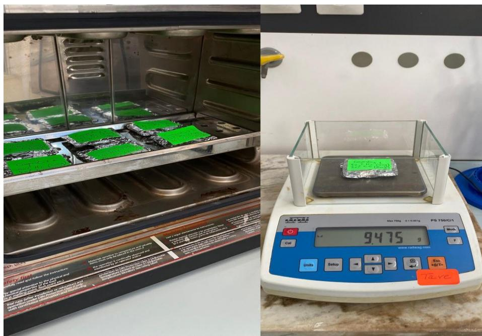
**Figure 16 :** Présentation de la méthode utilisée pour déterminer le taux d'humidité
