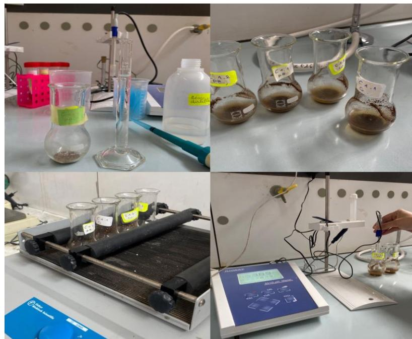
**Figure 14 :** Présentation de la méthode utilisée pour mesurer de pH
